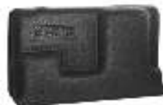
789 Изоляция для серий SATK15. Материал: Пенопласт PE-X сшитый полиэтилен с закрытыми ячейками. Минимальная толщина: 10 мм. Огнестойкость (DIN 4102): класс B2.
